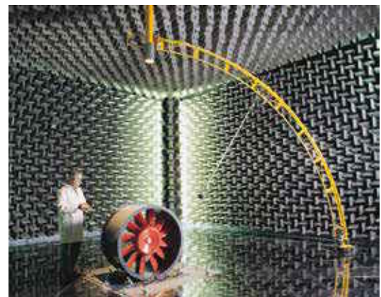
Cámara anecoica / Anechoic chamber
