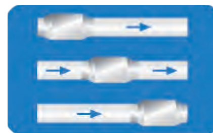
Τοποθέτηση σε οποιοδήποτε σημείο του αεραγωγού (στην αρχή, ενδιάμεσα, ή στο τέλος).
